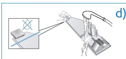
**Achtung!** Die Waschmittelschublade enthält elektrische Bauteile. Bei Kontakt mit Wasser können diese beschädigt werden. Deckel nicht in Wasser tauchen.
